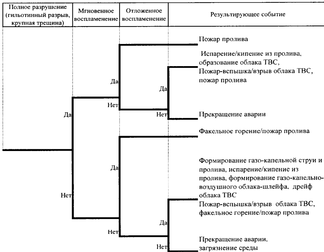
Рисунок 3 – Дерево событий развития аварии с образованием трещины на линейной части трубопровода ШФЛУ
